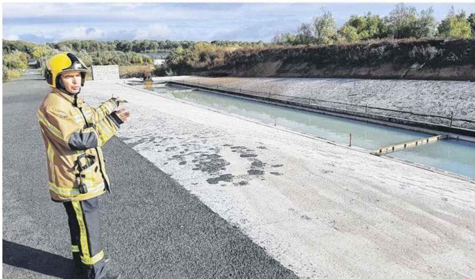
Sur cette cuvette de 300 m 2 , le Gesip étudie la propagation d'un feu face à la mousse d'extinction des incendies, utilisée également par les pompiers.
